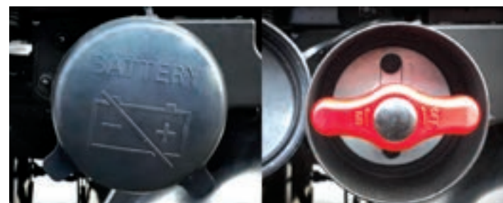
배터리 컷오프 스위치 장기 주차 시 배터리 방전 방지 및 편의성 증대
